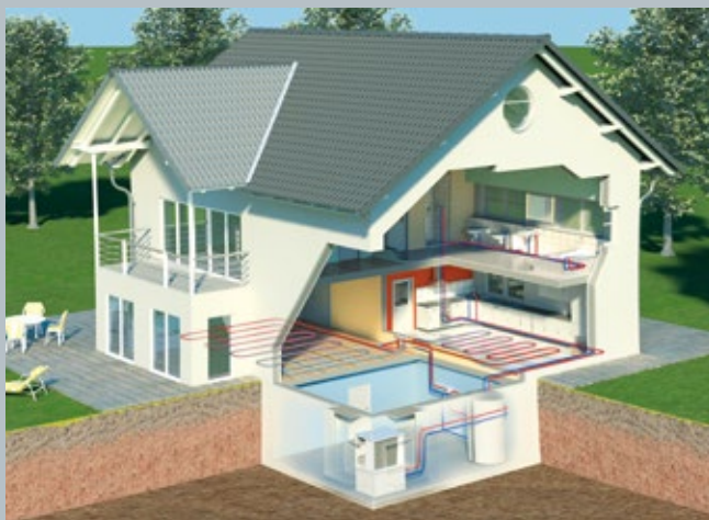
Innenaufstellung einer Wärmepumpe AEROTOP T
