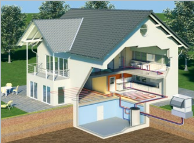
Außenaufstellung einer AEROTOP T Wärmepumpe
